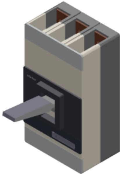
Leitungsschalter VL1600 UL; Typ PG (CAT NO. NPX3B160) non-interchangeable frame, mit Approbation Circuit-Breaker nach UL 489 Standardschaltvermögen 3-polig, NEMA Rating 35kA/480V, (molded case circuit breaker) Überstromauslöser TM, LI TU=40°C In=< 1600A, Bemessungsstrom II=7000...12000A Kurzschlusschutz IR=1600A Überstromauslöser für Anlagenschutz ohne Anschlusszubehör ohne Hilfsauslöser
