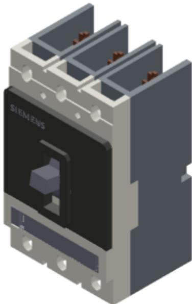
Leistungsschalter VL150 UL Typ DG (CAT NO. NDK3T100) non-interchangeable frame, mit Approbation Circuit-Breaker nach UL 489 Standardschaltvermögen 3-polig; NEMA Rating 35KA@480V und 18KA@600/347V (molded case circuit breaker) Überstromauslöser ETU, LSI TU=40°C In=100A, Bemessungsstrom ISD=1,5-10xIR, II=11 xIN Kurzschlusschutz Ir=40-100A Überstromauslöser für Anlagenschutz ohne Anschlusszubehör
