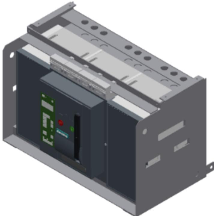
Einschub-Leistungsschalter approbiert nach UL 489 mit Einschubrahmen 3-polig, BG III, In=4000A AC 50/60Hz, IEC: bis 690V, 100kA bei 440V UL: 600Y/347, 100kA bei 480V mit Anschlussflansch
