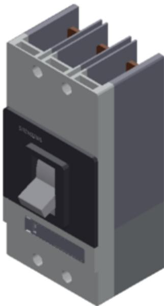
Leitungsschalter VL400 UL; Typ JG (CAT NO. NJX3V400) non-interchangeable frame, mit Approbation Circuit-Breaker nach UL 489 Standardschaltvermögen 3-polig, NEMA Rating 35kA/480V, (molded case circuit breaker) Überstromauslöser ETU, LSIG TU=40°C 3 Phasen/4 Leitungen In=400A, Bemessungsstrom ISD=1,5 bis 10xIR, II=11X in Kurzschlusschutz IR=200-400A Überstromauslöser für Anlagenschutz ohne Anschlusszubehör
