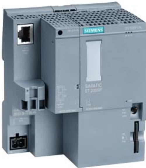
SIMATIC DP, CPU 1512SP-1 PN für ET 200SP, Zentralbaugruppe mit Arbeitsspeicher 200 KB für Programm und 1MByte für Daten, 1. Schnittstelle: PROFINET IRT mit 3 Port Switch, 48 NS Bit-Performance, SIMATIC Memory Card notwendig, Busadapter notwendig für Port 1 und 2
