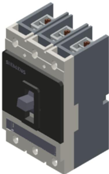
Leistungsschalter VL160H hohes Schaltvermögen  $I_{cu}=70\text{kA}$ , 415V AC 3-polig, Anlagenschutz Überstromauslöser LCD ETU42, LSIG 3 Phasen/4 Leitungen mit Anschlussleitung  $I_n=160\text{A}$ , Bemessungsstrom  $IR=64\ldots 160\text{A}$ , Überlastschutz,  $ISD=1,5$  bis  $10 \times IR$ ,  $II=11 \times I_n$  Kurzschlusschutz ohne Hilfsauslöser
