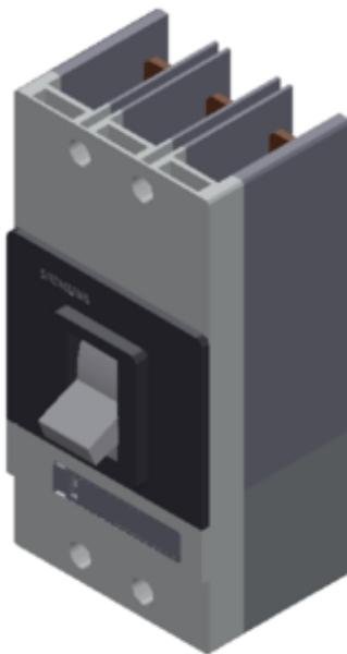
Leitungsschalter VL400 UL; Typ JG (CAT NO. LJX3R250) non-interchangeable frame, mit Approbation Circuit-Breaker nach UL 489 sehr hohes Schaltvermögen 3-polig, NEMA Rating 100kA/480V, (molded case circuit breaker) Überstromauslöser ETU, LI TU=40°C In=250A, Bemessungsstrom II=1,25 bis 11 xIn, Kurzschlusschutz IR=70-250A Überstromauslöser für Anlagenschutz ohne Anschlusszubehör
