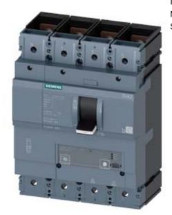
Leistungsschalter 3VA2 IEC Frame 630 Schaltvermögenklasse H Icu=85kA @ 415V 4-polig, Anlagenschutz ETU340, ELISA LI, In=630A Überlastschutz Ir=250A...630A Kurzschlussschutz Ii=9 x In N-Leiterschutz einstellbar (OFF, 50%, 100%) Schraubenflachanschluss
