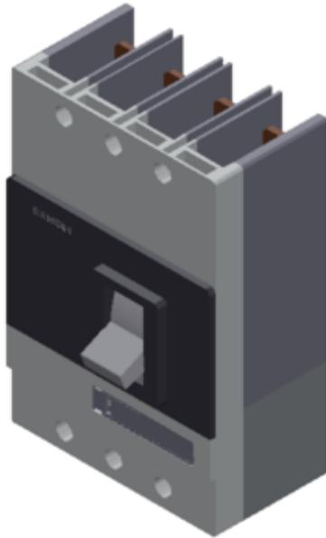
Leistungsschalter VL400L sehr hohes Schaltvermögen  $I_{cu}=100\text{kA}$ , 415V AC 4-polig, Anlagenschutz Überstromauslöser ETU20, LSI  $I_n=400\text{A}$ , Bemessungsstrom  $I_R=160\text{...}400\text{A}$ , Überlastschutz,  $ISD=1,5$  bis  $10 \times I_R$ ,  $II=11 \times I_N$  Kurzschlusschutz N geschützt ohne Hilfsauslöser ETU kommunikationsfähig
