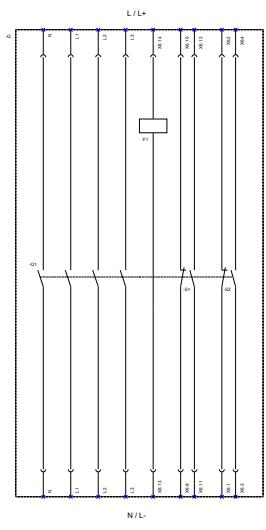
F1 (Hot auxiliary release / Heiße Hilfsablösung); 21 - 58 (Auxiliary switch / Hilfsschalter)
