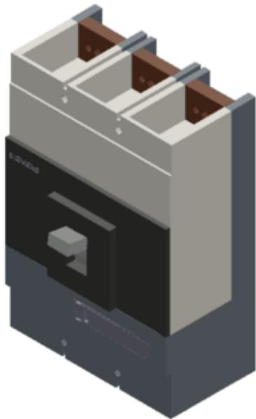
Leistungsschalter VL630N Standardschaltvermögen  $I_{cu}=55\text{kA}$ , 415V AC 3-polig, Anlagenschutz Überstromauslöser TM, LI  $I_{n}=315\text{A}$ , Bemessungsstrom  $I_{R}=250\ldots 315\text{A}$ , Überlastschutz, II=1575...3150A, Kurzschlusschutz
