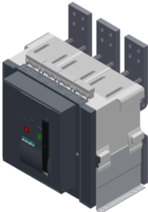
Festeinbau-Leistungstrennschalter approbiert nach UL 489 3-polig, Baugröße 2, In=2500A AC 50/60Hz, IEC: bis 690V, 100kA bei 440V UL: bis 600V, 100kA bei 480V Frontanschluss oben/unten Doppelloch
