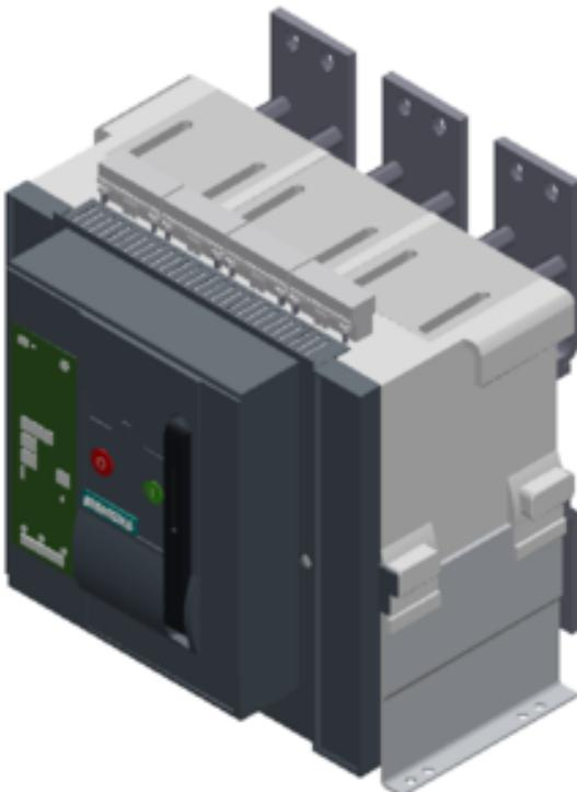
Festeinbau-Leistungsschalter approbiert nach UL 489 3-polig, Baugröße 2, In=2000A AC 50/60Hz, IEC: bis 690V, 100kA bei 440V UL: bis 600V, 100kA bei 480V
