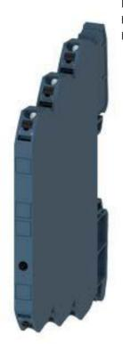
Eingangskoppler Relaiskoppler, 1 Wechsler hartvergoldet AC/DC 24 V Federzuganschluss (Push-In) Baubreite 6,2 mm thermischer Strom 6A
