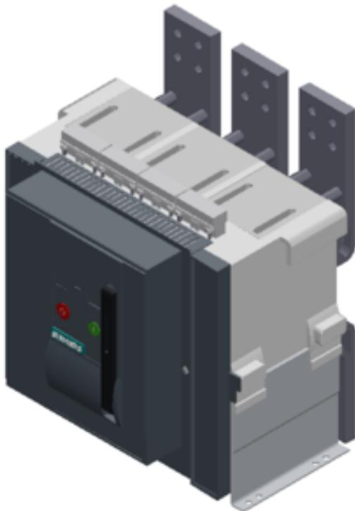
Festeinbau-Leistungstrennschalter 3-polig, Baugröße 2, IEC In=3200A bis 690V, AC 50/60Hz Icu=80kA bei 500V Frontanschluss oben/unten Doppelbohrung
