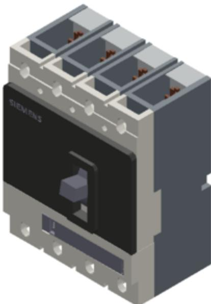
Leistungsschalter VL160N Standardschaltvermögen  $I_{cu}=55\text{kA}$ , 415V AC 4-polig, Anlagenschutz Überstromauslöser ETU20, LSI  $I_{n}=63\text{A}$ , Bemessungsstrom  $I_r=25\dots63\text{A}$ , Überlastschutz,  $ISD=1,5$  bis  $10 \times I_r$ ,  $II=11 \times I_r$  Kurzschlusschutz N geschützt mit Schraubanschluss ohne Hilfsauslöser Schiffbau Zertifikat für LRS, DNV und gL
