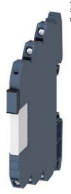
Ausgangskoppler mit steckbaren Relais, 1 Wechsler Schraubanschluss AC/DC 24 V Gehäusebreite 6,2 mm thermischer Strom 6A
