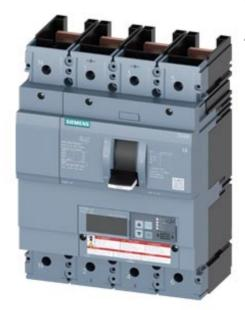
Leistungsschalter 3VA6 UL Frame 400 Schaltvermögenklasse L 150kA @ 480V 4-polig, Anlagenschutz ETU550, LSI, In=250A Überlastschutz Ir=100A...250A Kurzschlussschutz Isd=0,6..10x In, Ii=1,5..12x In N-Leiterschutz einstellbar (OFF, bis 160%) ohne Anschluss
