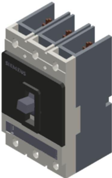
Leistungsschalter VL150 UL Typ DG (CAT NO. HDK3B090) non-interchangeable frame, mit Approbation Circuit-Breaker nach UL 489 hohes Schaltvermögen 3-polig; NEMA Rating 65KA@480V und 18KA@600/347V (molded case circuit breaker) Überstromauslöser TM, LI TU=40°C In=90A, Bemessungsstrom II=500...1000A Kurzschlusschutz Ir=90A Überstromauslöser für Anlagenschutz ohne Anschlusszubehör
