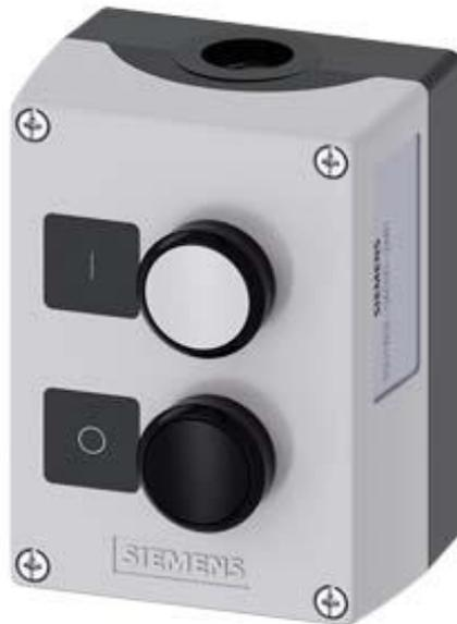
Gehäuse für Befehlsgeräte, 22 mm, rund, Gehäusematerial Kunststoff, Gehäuseoberteil grau, 2 Befehlsstellen Kunststoff, Vertiefung für Schilder, B=Drucktaster weiß, Schild: I, 1S, Schraubanschluss, A=Drucktaster schwarz Schild: O 1Ö, Schraubanschluss, Bodenbefestigung,
