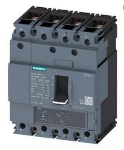
Leistungsschalter 3VA1 IEC Frame 160 Schaltvermögenklasse H Icu=70kA @ 415V 4-polig, Anlagenschutz TM220, ATFM, In=160A Überlastschutz Ir=112A...160A Kurzschlussschutz Ii=10 x In N-Leiterschutz 100% Schraubenflachanschluss
