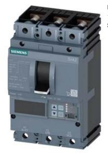
Leistungsschalter 3VA2 IEC Frame 100 Schaltvermögenklasse L Icu=150kA @ 415V 3-polig, Anlagenschutz ETU560, LSIG, In=63A Überlastschutz Ir=25A...63A Kurzschlussschutz Isd=0,6..10x In, li=1,5..12x In N-Leiterschutz optional mit externem Stromwandler, bis 160% Erdschlussschutz, abschaltbar Ig=0,25...1 x In, tg=0,05-0,8s Schraubenflachanschluss
