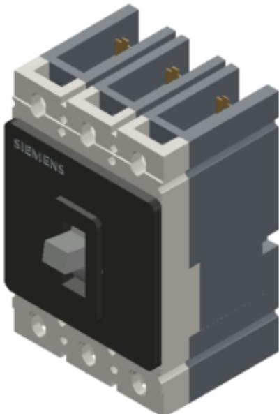
Leistungsschalter VL150X UL, Typ CG (CAT NO. HCS3S100) non-interchangeable frame, mit Approbation Circuit Breaker nach UL 489 Standardschaltvermögen 3-polig, NEMA Rating 35kA/480V (molded case switch) Überstromauslöser magnetisch TU=40°C In=<100A Bemessungsstrom II=1800A Kurzschlusschutz ohne Anschlusszubehör
