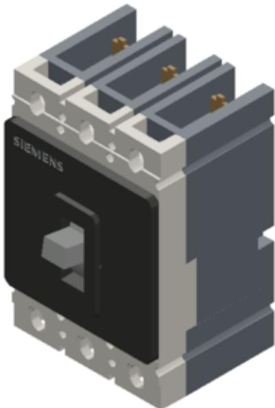
Leistungsschalter VL150X UL, Typ CG (CAT NO. HCS3S150) non-interchangeable frame, mit Approbation Circuit Breaker nach UL 489 Standardschaltvermögen 3-polig, NEMA Rating 35kA/480V (molded case switch) Überstromauslöser magnetisch TU=40°C In=<150A Bemessungsstrom II=1800A Kurzschlusschutz ohne Anschlusszubehör
