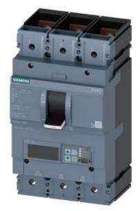
Leistungsschalter 3VA2 IEC Frame 630 Schaltvermögenklasse M Icu=55kA @ 415V 3-polig, Anlagenschutz ETU860, LSIG, In=630A Überlastschutz Ir=250A...630A Kurzschlussschutz Isd=0,6..9x In, Ii=1,5..9x In N-Leiterschutz optional mit externem Stromwandler, bis 160% Erdschlussschutz, abschaltbar Ig=0,2...1 x In, tg=0,05-0,8s Schraubenflachanschluss
