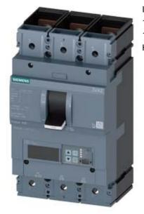
Leistungsschalter 3VA2 IEC Frame 630 Schaltvermögenklasse M lcu=55kA @ 415V 3-polig, Anlagenschutz ETU850, LSI, In=630A Überlastschutz Ir=250A...630A Kurzschlussschutz Isd=0,6...9 x In, li=1,5...9 x In N-Leiterschutz optional mit externem Stromwandler, bis 160% Schraubenflachanschluss Spannungsauslöser (STL) 110-127V DC, AC 50/60Hz 2 Hilfsschalter HQ 1 Ausgelöst-Meldeschalter HQ 1 Schutzauslösung-Meldeschalter
