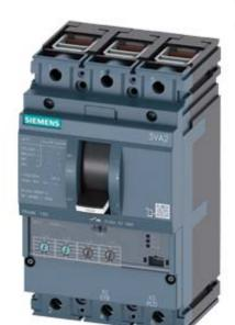
Leistungsschalter 3VA2 IEC Frame 160 Schaltvermögenklasse M Icu=55kA @ 415V 3-polig, Anlagenschutz ETU330, LIG, In=40A Überlastschutz Ir=16A...40A Kurzschlussschutz Ii=1,5...12 x In Erdschlussschutz Ig=0,4... 1 x In, tg=0,1/0,3s Klemmenanschluss
