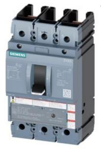
Leistungsschalter 3VA5 UL Frame 250 Schaltvermögenklasse H 65kA @ 480V 2-polig, Anlagenschutz TM210, FTFM, In=100A Überlastschutz Ir=100A fest eingestellt Kurzschlussschutz Ii=10 x In ohne Anschluss
