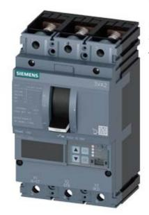
Leistungsschalter 3VA2 IEC Frame 160 Schaltvermögenklasse H Icu=85kA @ 415V 3-polig, Anlagenschutz ETU560, LSIG, In=40A Überlastschutz Ir=16A...40A Kurzschlussschutz Isd=0,6..10x In, Ii=1,5..12x In N-Leiterschutz optional mit externem Stromwandler Erdschlussschutz, abschaltbar Ig=0,4... 1 x In, tg=0,05-0,8s Schraubenflachanschluss Unterspannungsauslöser (UVR) 208-230V AC 50/60Hz 2 Hilfsschalter HQ 1 Ausgelöst-Meldeschalter HQ
