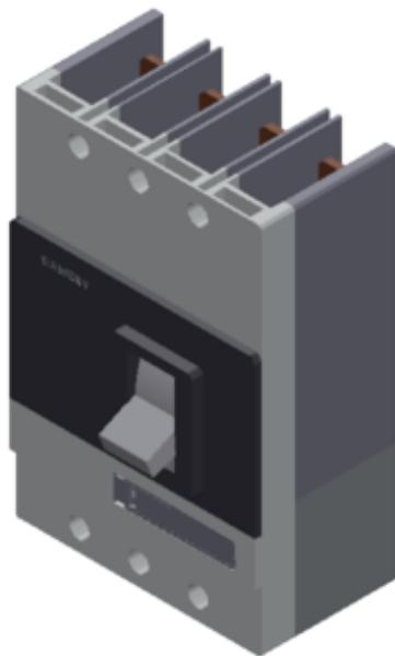
Leistungsschalter VL400N Standardschaltvermögen  $I_{cu}=55\text{kA}$ , 415V AC 4-polig, Anlagenschutz Überstromauslöser ETU10, LI  $I_{n}=315\text{A}$ , Bemessungsstrom  $I_{R}=128\ldots315\text{A}$ , Überlastschutz,  $II=1,25$  bis 11 xIN, Kurzschlusschutz
