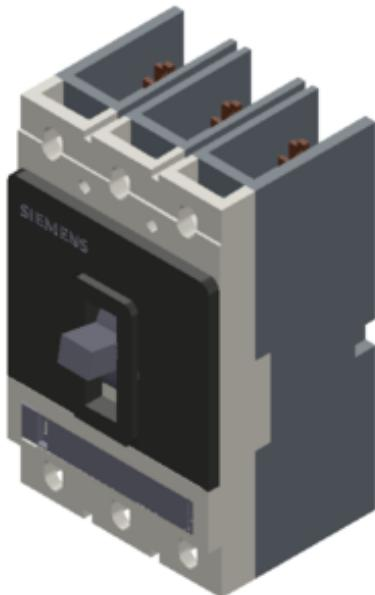
Leistungsschalter VL150 UL Typ DG (CAT NO. HDK3R150) non-interchangeable frame, mit Approbation Circuit-Breaker nach UL 489 hohes Schaltvermögen 3-polig; NEMA Rating 65KA@480V und 18KA@600/347V (molded case circuit breaker) Überstromauslöser ETU, LI TU=40°C In=150A, Bemessungsstrom II=1,25-11 xIN, Kurzschlusschutz Ir=60-150A Überstromauslöser für Anlagenschutz ohne Anschlusszubehör
