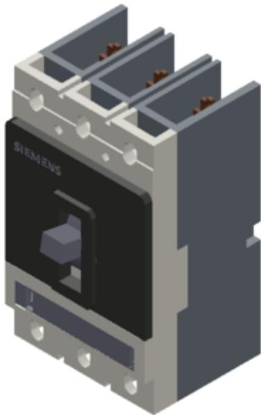
Leistungsschalter VL150 UL Typ DG (CAT NO. HDK3B150) non-interchangeable frame, mit Approbation Circuit-Breaker nach UL 489 hohes Schaltvermögen 3-polig; NEMA Rating 65KA@480V und 18KA@600/347V (molded case circuit breaker) Überstromauslöser TM, LI TU=40°C In=150A, Bemessungsstrom II=800...1600A Kurzschlusschutz Ir=150A Überstromauslöser für Anlagenschutz ohne Anschlusszubehör
