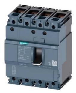
Leistungsschalter 3VA1 IEC Frame 100 Schaltvermögenklasse S Icu=36kA @ 415V 4-polig, Anlagenschutz TM210, FTFM, In=20A Überlastschutz Ir=20A fest eingestellt Kurzschlussschutz Ii=16 x In N-Leiter ungeschützt Schraubenflachanschluss
