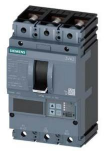
Leistungsschalter 3VA2 IEC Frame 250 Schaltvermögenklasse M Icu=55kA @ 415V 3-polig, Motorschutz ETU860M, LSIG, In=200A Überlastschutz Ir=80A...200A Kurzschlussschutz Isd=1,2..15x In, Ii=3..15x In Erdschlussschutz, abschaltbar Ig=0,2...1 x In, tg=0,05-0,8s Schraubenflachanschluss
