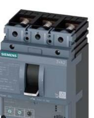
Leistungsschalter 3VA2 IEC Frame 250 Schaltvermögenklasse M Icu=55kA @ 415V 3-polig, Motorschutz ETU350M, LSI, In=160A Überlastschutz Ir=63A...160A Kurzschlussschutz Isd=3...15 x Ir, Ii=15 x In Schraubenflachanschluss
