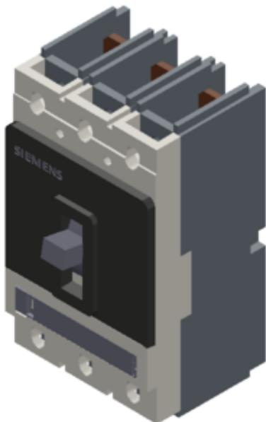
Leitungsschalter VL250 UL Typ FG (CAT NO. HFK3V150) non-interchangeable frame, mit Approbation Circuit-Breaker nach UL 489 hohes Schaltvermögen 3-polig; NEMA Rating 65KA@480V und 18KA@600/347V (molded case circuit breaker) Überstromauslöser ETU, LSIG TU=40°C 3 Phasen/4 Leitungen In=150A, Bemessungsstrom ISD=1,5-10xIR, II=11 xIN Kurzschlusschutz IR=60-150A Überstromauslöser für Anlagenschutz ohne Anschlusszubehör
