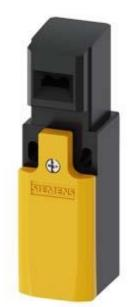
Sicherheits-Positionsschalter mit getrenntem Betätiger, Kunststoffgehäuse 31 mm nach DIN EN 50047, mit erhöhtem Korrosionsschutz, Geräteanschluss 1x (M20x 1,5) 1S/1Ö Schleichschaltglieder, funktionsfähig bei -40 °C, Betätiger 3SE5000-0AV0. muss separat bestellet werden
