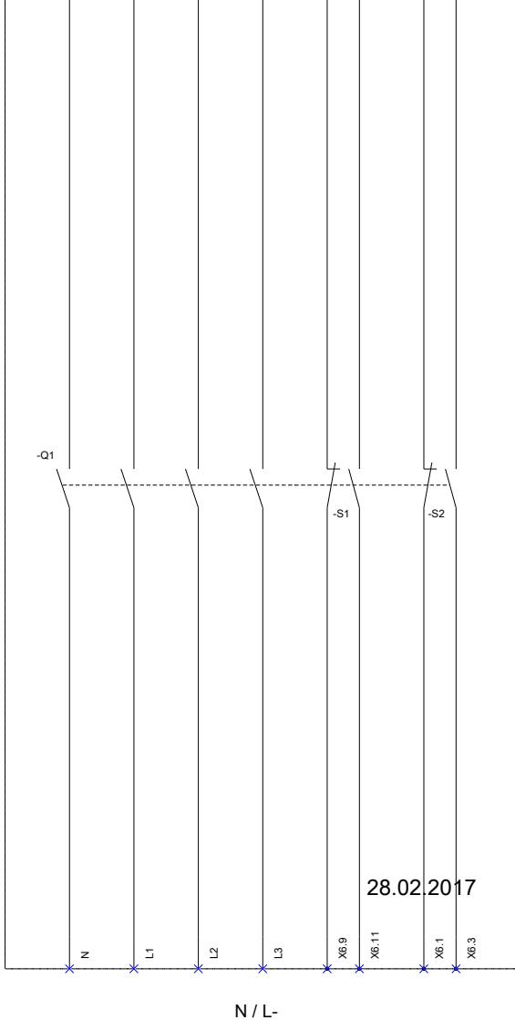
S1 - S8 (Auxiliary switch / Hilfschalter);
