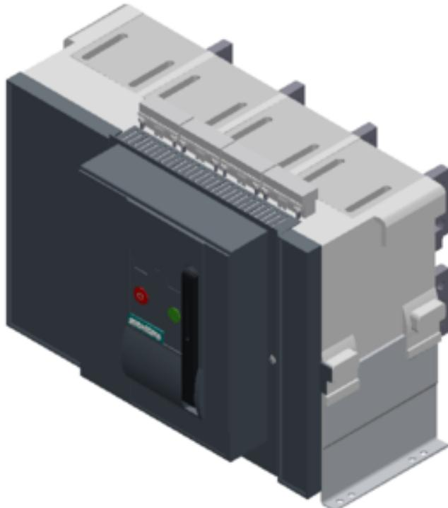
Festeinbau-Leistungstrennschalter 4-polig, Baugröße 2, IEC In=2500A bis 690V, AC 50/60Hz Icu=66kA bei 500V Anschluss rückseitig vertikal
