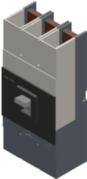
Leitungsschalter VL800 UL; Typ MG (CAT NO. HMX3R600) non-interchangeable frame, mit Approbation Circuit-Breaker nach UL 489 hohes Schaltvermögen 3-polig, NEMA Rating 65kA/480V, (molded case circuit breaker) Überstromauslöser ETU, LI TU=40°C In=600A, Bemessungsstrom II=1,25 bis 10xIN, Kurzschlusschutz IR=200-600A Überstromauslöser für Anlagenschutz ohne Anschlusszubehör
