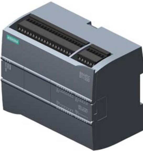
SIPLUS S7-1200 CPU 1215C DC/DC/Relais fuer mediale belastung mit conformal coating based on 6ES7215-1HG40-0XB0 . Kompakt-CPU, DC/DC/Relais, 2 PROFINET Port, onboard I/O: 14 DI DC 24V 10 DO Relais 2A, 2 AI 0-10V DC 2 AO 0-20mA DC, Stromversorgung: DC 20,4-28,8V DC, Programm-/Datenspeicher 100 KB
