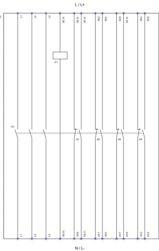
F1 (1st auxiliary release / Erster Hilfsauslöser); S1 - S8 (Auxiliary switch / Hilfsschalter);
