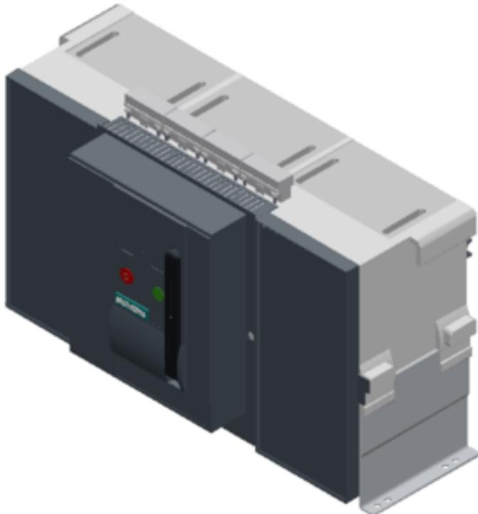
Festeinbau-Leistungstrennschalter 3-polig, Baugröße 3, IEC In=4000A bis 690V, AC 50/60Hz Icu=100kA bei 500V Anschluss rückseitig horizontal
