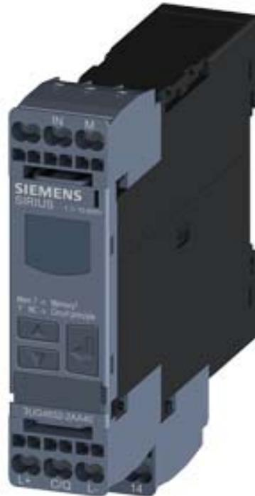
Digitales Überwachungsrelais Spannungsüberwachung, 22.5 mm für IO-Link AC/DC 10...600 V Über-und Unterspannung Hysterese 0.1 bis 300 V Anlaufverzögerungszeit Auslöseverzögerungszeit 1 Wechsler, Federzugtechnik
