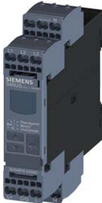
Digitales Überwachungsrelais für 3-Phasen-Spg. mit N-Leiter für IO-Link AC 50...60 Hz 3 x 160 bis 690 V
