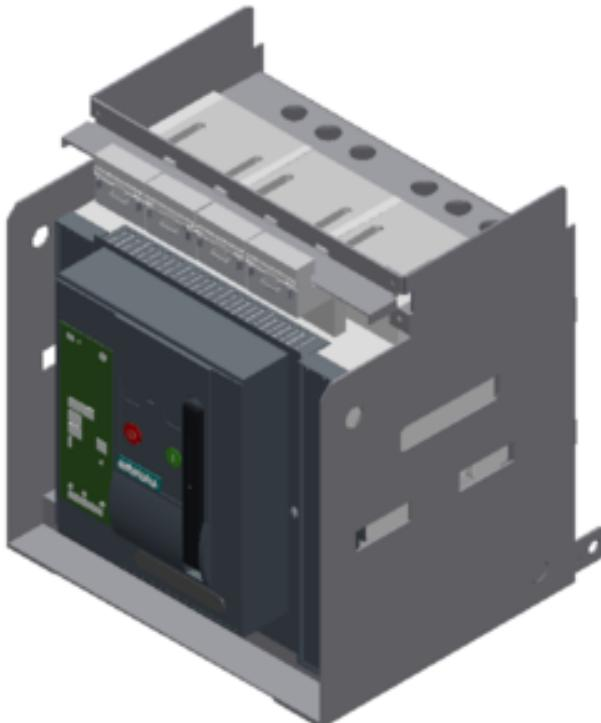
Einschub-Leistungsschalter mit Einschubrahmen 3-polig, Baugröße 2, IEC In=3200A bis 690V, AC 50/60Hz
