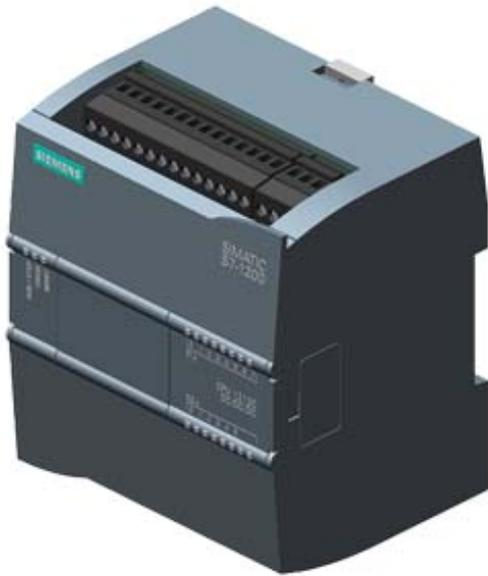
SIPLUS S7-1200 CPU 1212C DC/DC/DC -40...+70°C mit conformal coating based on 6ES7212-1AE40-0XB0 . Kompakt-CPU, DC/DC/DC, onboard I/O: "8 DI DC 24V;" "6 DO 24V DC;" 2 AI 0-10V DC, Stromversorgung: 20,4-28,8V DC, Programm-/Datenspeicher 50 KB
