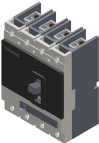
Leistungsschalter VL160N Standardschaltvermögen Icu=55kA, 415V AC 4-polig, Anlagenschutz Überstromauslöser TM, LI In=125A, Bemessungsstrom IR=100...125A, Überlastschutz, II=625...1250A, Kurzschlusschutz N ungeschützt
