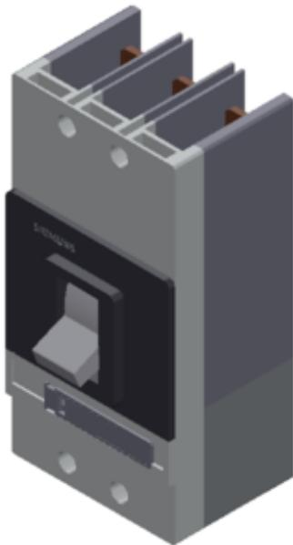
Leitungsschalter VL400 UL Typ JG (CAT NO. HJX3G400) non-interchangeable frame, mit Approbation Circuit-Breaker nach UL 489 hohes Schaltvermögen 3-polig; NEMA Rating 65kA/480V und 25kA/600V (molded case circuit breaker) Überstromauslöser LCD ETU, LSIG TU=40°C 3 Phasen/4 Leitungen In=400A, Bemessungsstrom ISD=1,25-10xIR, II=11X in Kurzschlusschutz IR=150-400A Überstromauslöser für Anlagenschutz
