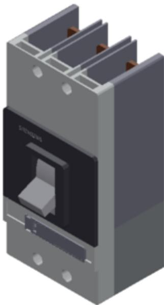
Leitungsschalter VL400X UL Typ LG (CAT NO. HLK3G600) non-interchangeable frame, mit Approbation Circuit-Breaker nach UL 489 hohes Schaltvermögen 3-polig; NEMA Rating 65kA/480V und 18kA/600V (molded case circuit breaker) Überstromauslöser LCD ETU, LSIG TU=40°C 3 Phasen/4 Leitungen In=600A, Bemessungsstrom ISD=1,25-10xIR, II=10xIN Kurzschlusschutz IR=200-600A Überstromauslöser für Anlagenschutz ohne Anschlusszubehör
