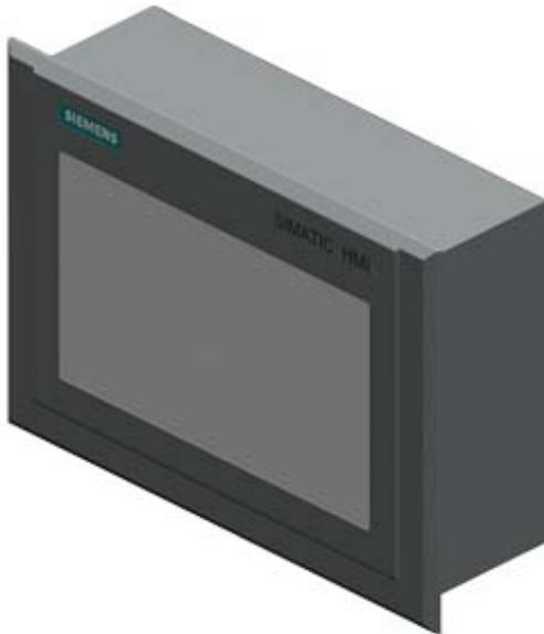
SIPLUS HMI TP700 Comfort Outdoor conformal coating -30 ... +60°C based on 6AV2124-0GC13-0AX0 . Comfort Panel, Touchbedienung, 7" WIDESCREEN-TFT-Display, 16 Mio Farben, PROFINET Schnittstellen, MPI/PROFIBUS DP Schnittstelle, 12 MB Projektierungsspeicher, WINDOWS CE 6.0, Projektierbar ab WINCC Comfort V13 SP1, HSP
