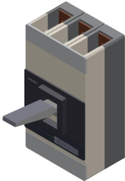
Leitungsschalter VL1600 UL Typ PG (CAT NO. HPX3G120) non-interchangeable frame, mit Approbation Circuit-Breaker nach UL 489 hohes Schaltvermögen 3-polig; NEMA Rating 65kA/480V und 35kA/600V (molded case circuit breaker) Überstromauslöser LCD ETU, LSIG TU=40°C 3 Phasen/4 Leitungen In=1200A, Bemessungsstrom ISD=1,25-10xIR, II=10xIN Kurzschlusschutz IR=400-1200A Überstromauslöser für Anlagenschutz
